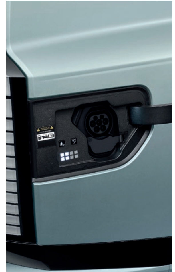
Trappe de recharge électrique
